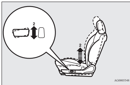
2 — подъем и опускание задней части подушки
